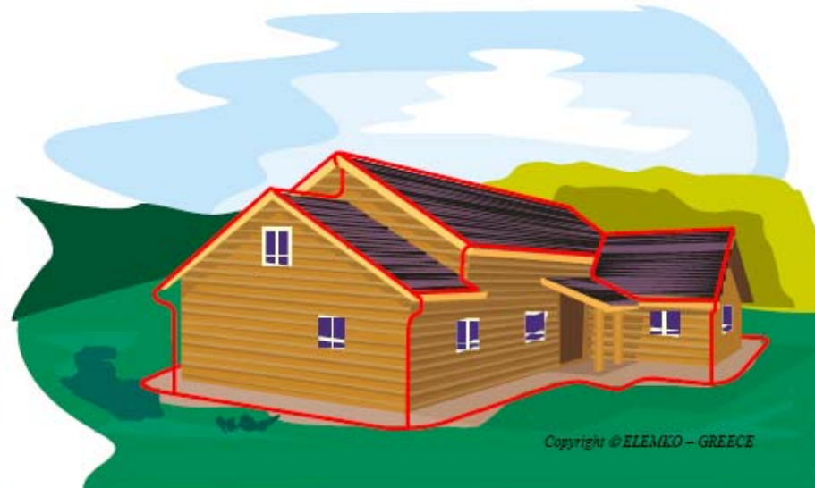
Figure 9 : Prise de terre de type B
