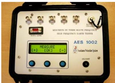
← Mesureur d'impédance de terre en Haute Fréquence, Résultat de mesure: Variation de l'impédance en fonction de la fréquence →
