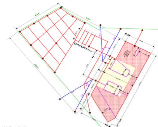
Réseau de terre modélisé sur une installation
