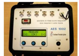
Appareil de mesure de terre haute fréquence
