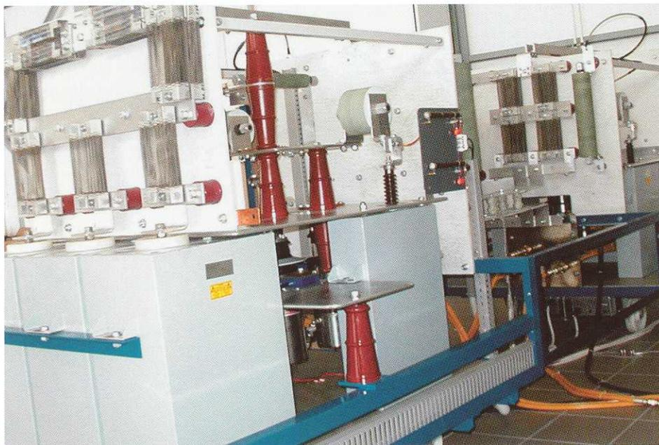
Notre générateur de choc de courant est capable de délivrer, en plus des formes d'onde typiques 8/20  $\mu$ s, 8/80  $\mu$ s et 10/350  $\mu$ s, des chocs de courant de n'importe quelle forme d'onde avec un temps de front  $T_f=4$  et un temps de queue  $T_r=20$  jusqu'à 500  $\mu$ s.
